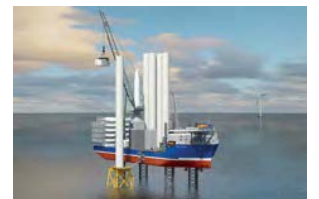
OFFSHORE. Mit dem WTIV (Wind Turbine Installation Vessel) „Blue Amber“ können zukünftige Windkraftanlagen größer als 10 MW installiert werden.
