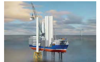
OFFSHORE. Mit dem WTIV (Wind Turbine Installation Vessel) „Blue Amber“ können zukünftige Windkraftanlagen größer als 10 MW installiert werden.
